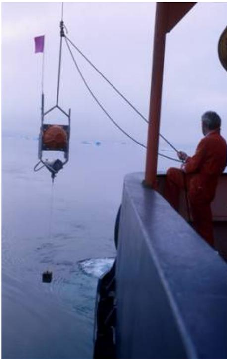
Abbildung 3: OBS-Aussetzen bei langsamer Fahrt des Schiffes
