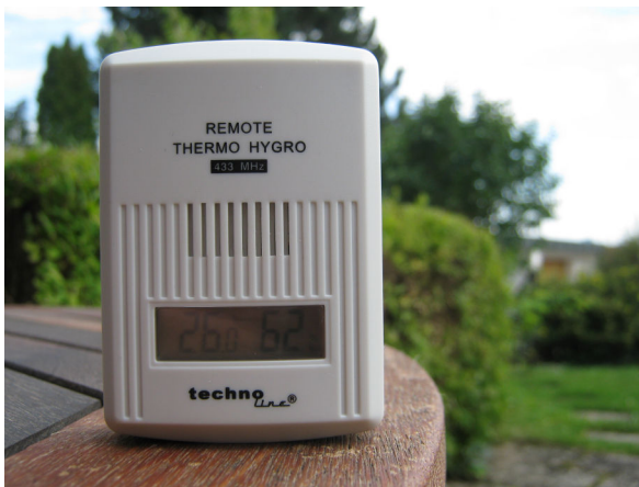
Abbildung 1: Ein Außensensor von Technoline (TX3-TH) für Temperatur und Luftfeuchte
