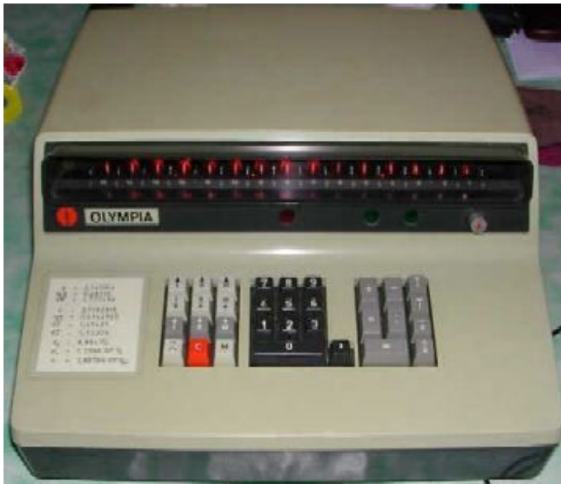
Die Olympia RAE 4/30-3 Rechenmaschine von Olympia in Wilhelmshaven realisierte schon 1966 doppelgenaue Multiplikation (Quelle: oldcalculatormuseum.com, Photo: Serge Devidts)
